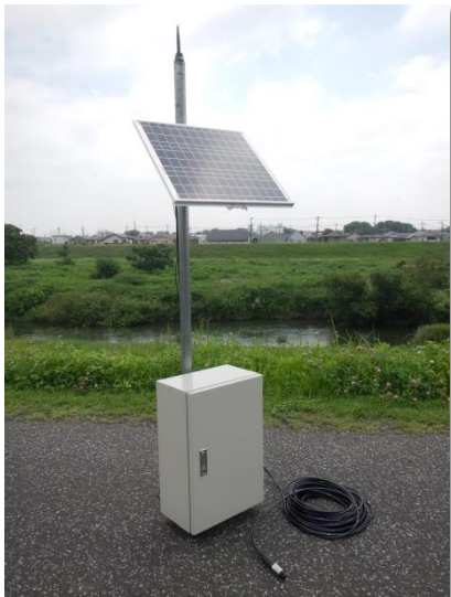
図 1. 自然環境監視 Mu センサシステム 携帯エリア外の山間部の監視に容易に設置可能
