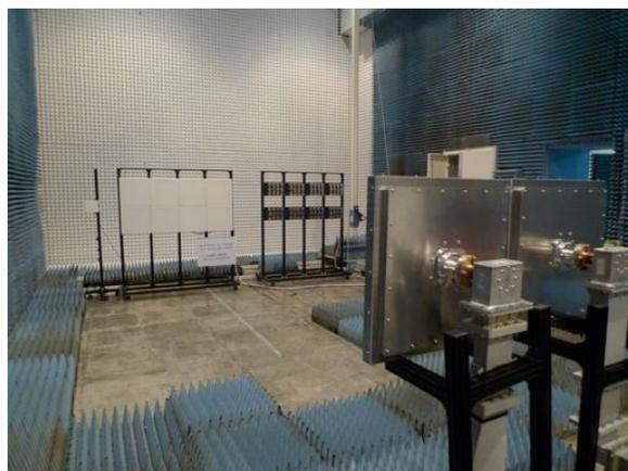
レクテナとは、受電側すなわち車両側に取り付けられるアンテナならびに整流回路の総称で、今回の実験では送信側より4~6m離れた場所へ10kWクラスの給電を行い、4m離れた場所ではレクテナ効率80%という従来比で2倍近い効率を実現することに成功。世界最高出力(3.2kW/m<sup>2</sup>以上)を実現しました。
